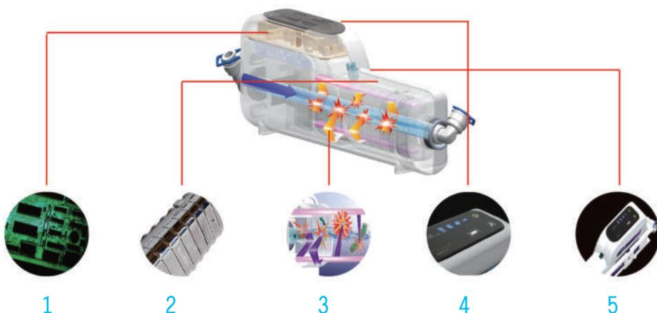
1 | 內建數位裝置以精準紫外線照射、水流偵測、定時自動滅菌程控
